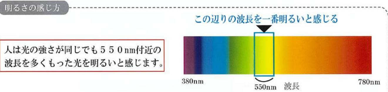
ピカルームに配合されている粒子は光が明るく感じる550nm付近の波長を効果的に反射します。そのため、ピカルームを塗った空間は実際の光の強さよりも明るく感じます。
